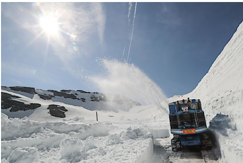
Schneeräumung auf der Großglockner Hochalpenstraße in Salzburg/Kärnten - Durchstich vor der Verkehrsfreigabe. Die von Erbauer der Großglockner Hochalpenstraße DI Franz Wallack konstruierten Rotationspflüge erledigen auch heute noch den Großteil der Schneeräumung auf der beliebten Ausflugsstraße. Heute erfolgte nach intensiver dreiwöchiger Räumarbeit, bei der 700.000 Kubikmeter Schnee bewegt wurden, der Durchstich auf 2.500 Meter Höhe.
